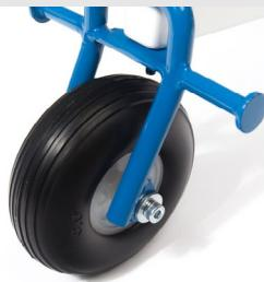
Fixer la roue à l'aide d'une vis CHC M4-40. Mettre en premier l'écrou frein M4, le serrer suffisamment sans empêcher la rotation de la roue sur la vis. Ensuite insérer l'ensemble sur l'essieu arrière et serrer l'écrou frein contre l'essieu. La roue doit conserver une rotation libre.
