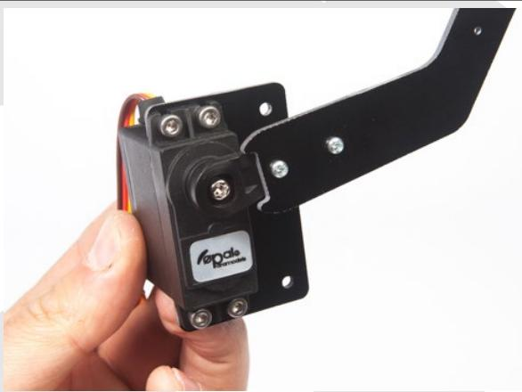
Positionieren Sie das Ganze wie auf dem Bild gezeigt und ziehen Sie das Ganze mit CHC M3-20 Schrauben, Unterlegscheiben und Muttern fest.
