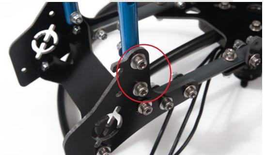
Dann befestigen Sie an diesem U-Stahlteil das andre Verbindungsteil mit 2x CHC M3-16 Schrauben, 4 Unterlegscheiben und 2 Muttern
