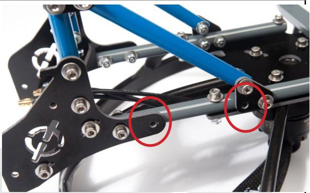
Platzieren Sie den Servomotor auf der Platte und verwenden Sie 4 x CHC M3-8 Schrauben und Muttern
