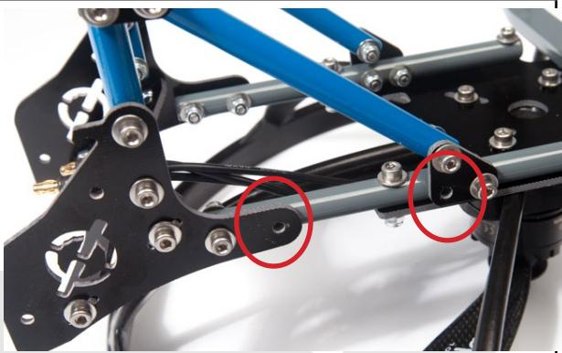
Montez le servomoteur sur la platine à l'aide de 4 vis CHC M3-8 et écrous freins.
