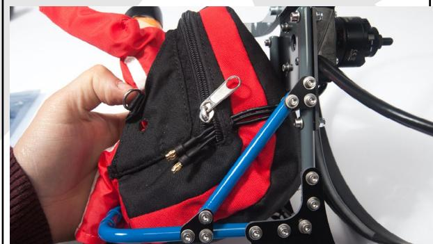
Verbinden Sie dann den Regler mit dem Motor. Achten Sie jedoch auf die Motordrehung. Wenn die Drehung umgekehrt werden soll, müssen Sie nur 2 Drähte von den 3 gewechselt werden (lesen Sie das ESC-Handbuch für weitere Details)
