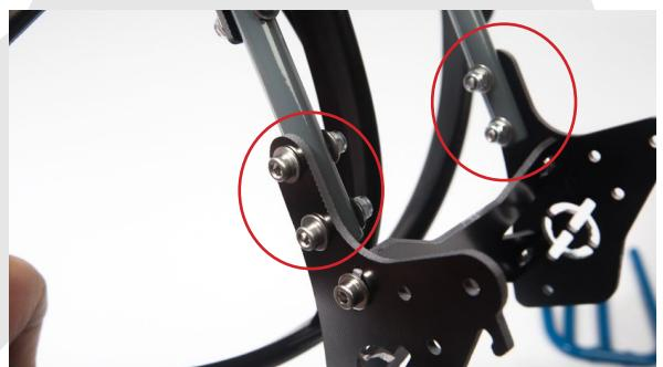
Platzieren Sie das U-Stahlteil und befestigen Sie es wie in der Abbildung gezeigt mit 4 Schrauben, Unterlegscheiben und Muttern aus CHC M3-16 am vorherigen Teil.
