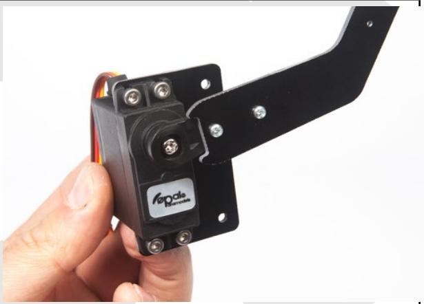
Positionner l'ensemble comme sur la photo ci-contre et fixez l'ensemble à l'aide de vis CHC M3-20 , avec rondelles et écrous freins.
