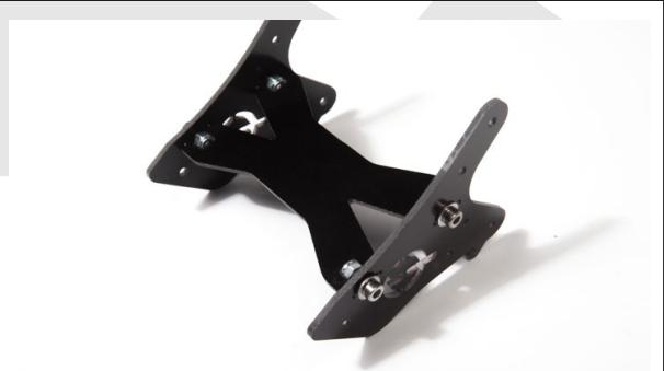
Montez la base sur les barres latérales à l'aide de 4 vis CHC M3-16, rondelles et écrous freins.
